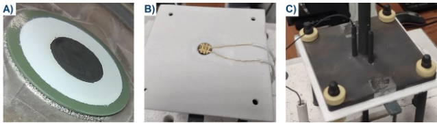
Rys.1. Proces przygotowania ogniwa do pomiaru. Ułożenie ogniwa na piance niklowej (A), uszczelnienie układu i ułożenie złotej siatki (B), montaż docisku (C)
