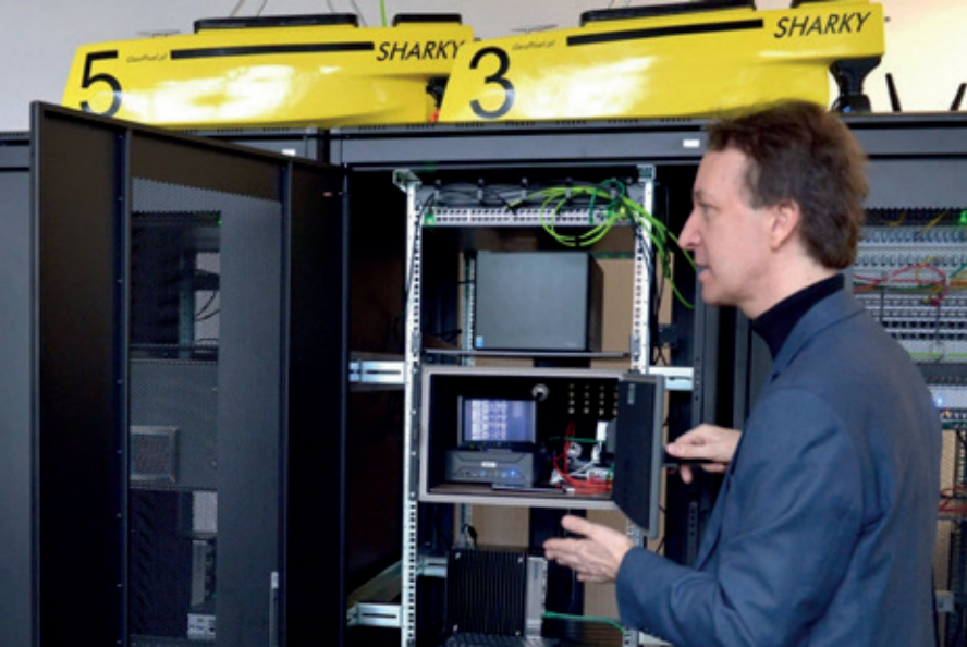
Fot. 2. Dr inż. Krzysztof Gierłowski prezentuje umieszczony w tzw. shieldboksie kompletny system 5G umożliwiający zdalną realizację eksperymentów. Na szafach, powyżej shieldboksa, widoczne są dwa autonomiczne pojazdy pływające (z floty pięciu jednostek) przeznaczone do specjalistycznych badań na akwenach wodnych
