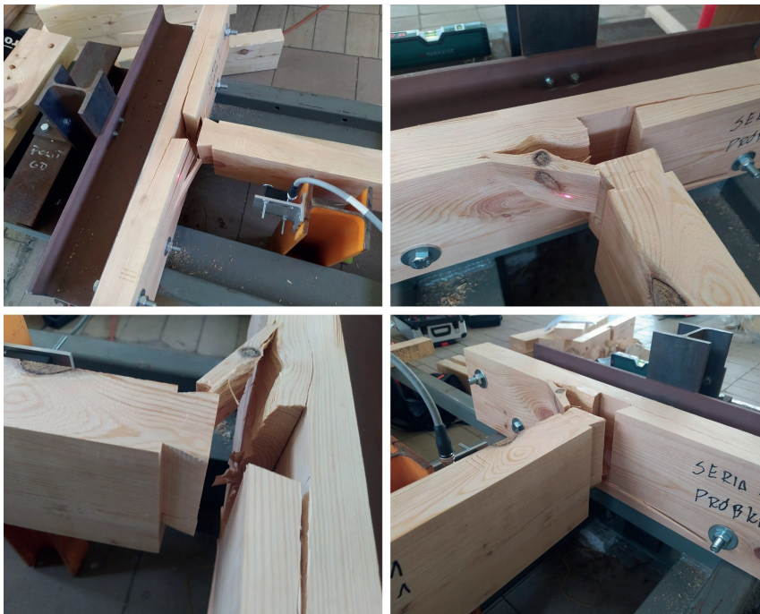
Fot. 3. Przykłady uszkodzeń próbek; źródło: opracowanie własne
