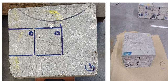
Rys. 12.3. Próbkę przycięte do wymiarów normowych, pobrane z posadzki w ramach badań polowych (fot. S. Świątek-Żołyńska)
