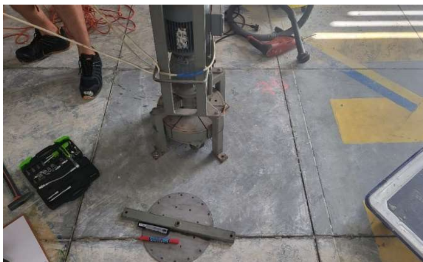
Rys. 12.5. Pomiar metodą BCA posadzki w ramach badań polowych ( fol. S. Świątek-Żołyńska )
