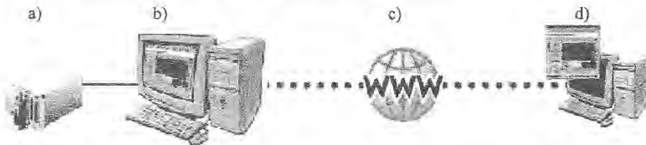
Rys. 1. Struktura przyrządu wirtualnego obsługiwanego z przeglądarki internetowej: a) sprzętowa część pomiarowa, b) komputer z oprogramowaniem przyrządu wirtualnego i serwerem WWW, c) sieć komputerowa Internet, d) komputer z przeglądarką internetową
