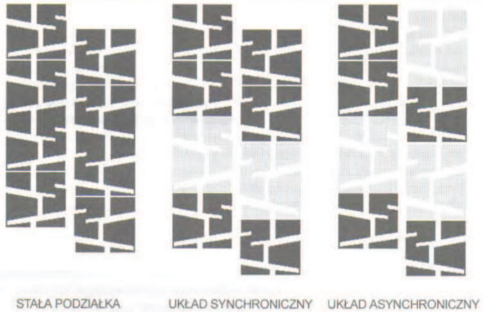
Rys. 6. Trzy typowe układy segmentów bieżnika. Fig. 6. Three typical thread segments system
