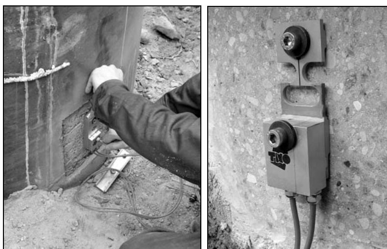
Rys. 4. Czujniki zamontowane na palu
