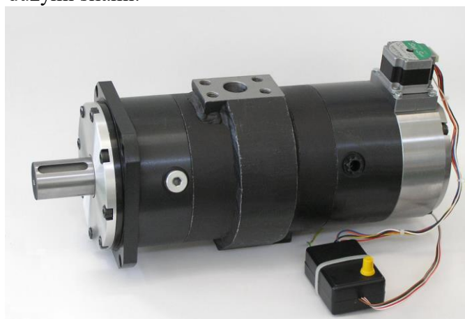
Rys. 7. Pompa z krzywką obracaną przez silnik krokowy.
