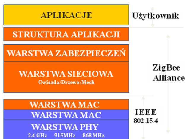
Rys. 1. Częstotliwości pracy dostępne w standardzie ZigBee
