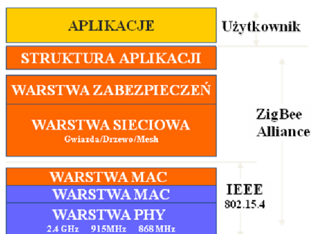
Rys. 1. Częstotliwości pracy dostępne w standardzie ZigBee
