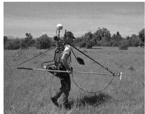
Rys. 9. System magnetometryczny z magnetometrem pompowanym optycznie (www.geometrics.com)
