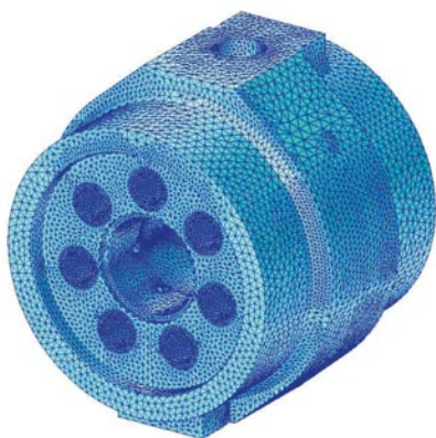
Rys. 8. Model MES korpusu pompy PWKZ-78
