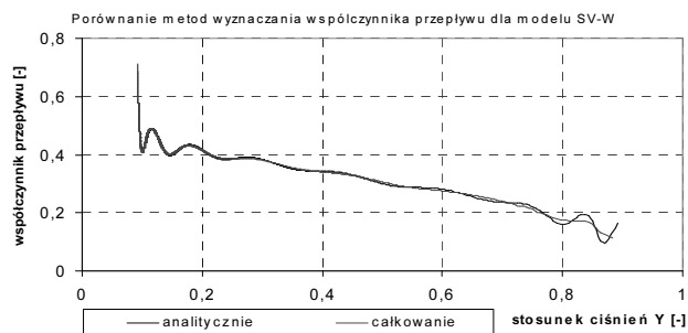
Rys. 6. Zależność współczynnika przepływu \mu od stosunku ciśnień Y dla różnych metod obliczeń
