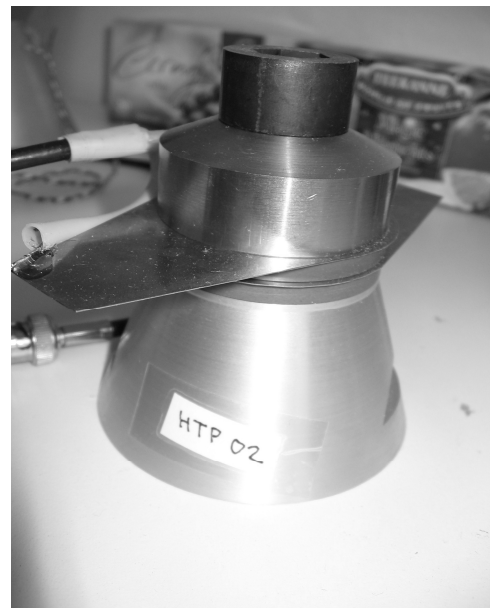
Rys. 3. Transmitter sygnału ultradźwiękowego z czujnikiem piezoelektrycznym
