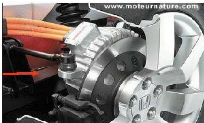
Rys. 6. Silnik trójfazowy napędzający przednie skrzętne koło samochodu marki Honda. Widać końcówkę drążka kierowniczego oraz tarczę hamulcową. Aluminiowy korpus silnika został uźbrowany w celu uzyskania lepszej wymiany ciepła
