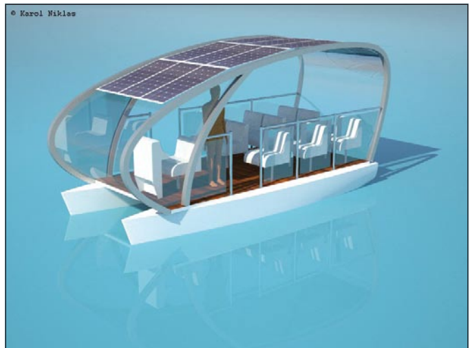
Rys. 14. Zasilany energią słoneczną katamaran ECOENERGA, mogący zabrać na swój pokład ponad dziesięciu pasażerów (wizualizacja K. Niklas)
