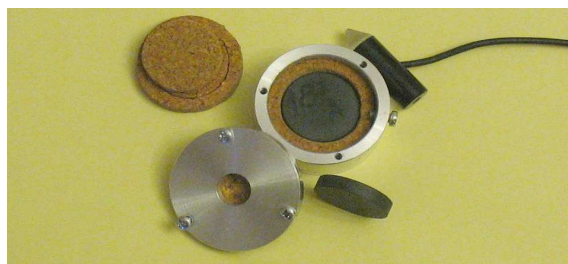
Rys. 6. Głowica mechaniczna z czujnikami do ultradźwiękowej spektroskopii rezonansowej warystorów
