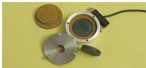
Rys. 6. Głowica mechaniczna z czujnikiem do ultradźwiękowej spektroskopii rezonansowej warystorów
