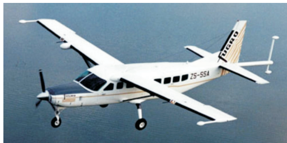
Rys. 3. System magnetometryczny TRIAX na samolocie typu Caravan (www.fugro.com)
