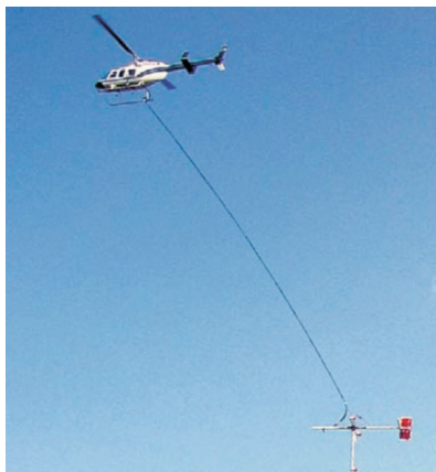
Rys. 4. Czujniki magnetyczne zamontowane w tzw. gondoli ciągniętej na kablolinie przez śmigłowiec
