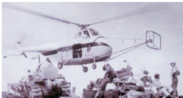
Rys. 7. System elektromagnetyczny zainstalowany na helikopterze
