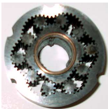
Rys.3. Mechanizm roboczy silnika satelitowego oraz miejsca występowania strat objętościowych
