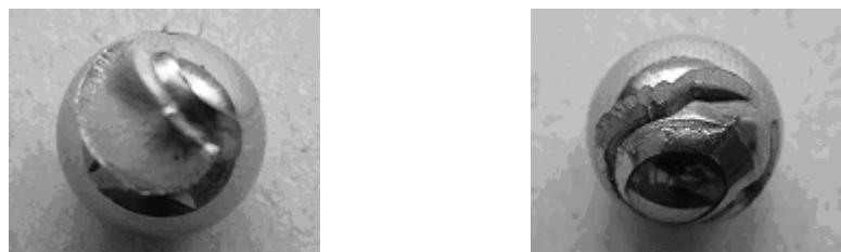
Rys. 11. Charakter pęknięcia kulki górnej obciążonego czterokulowego wężła tarcia tocznego smarowanego wodą destylowaną [L. 10, 11]
