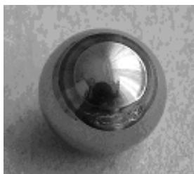
Rys. 12. Charakter zużycia kulki górnej obciążonego czterokulowego wężła tarcia tocznego smarowanego olejem Total Azolla 46 [L. 10, 11]
