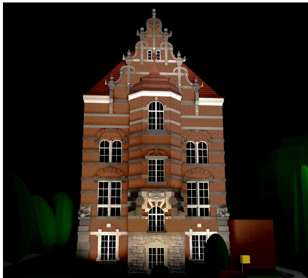
Rys. 6. Wizualizacja iluminacji z wykorzystaniem naświetlaczy umieszczonych na poziomie ziemi oraz na dwóch słupach
