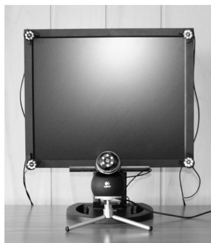
Rys. 1. System śledzenia punktu fiksacji wzroku
