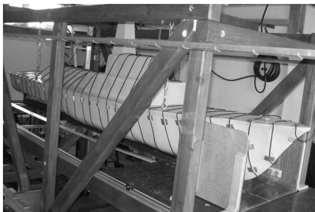
Rys.1. Model okrętu na stanowisku badawczym
