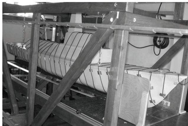
Rys. 1. Model okrętu na stanowisku badawczym
