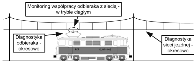
Rys. 1. Stan diagnostyki systemu odbioru prądu
