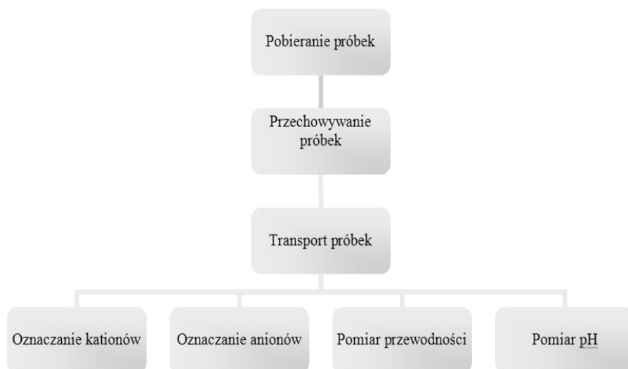
Rys. 2. Schemat postępowania z próbkami przeznaczonymi do badań
