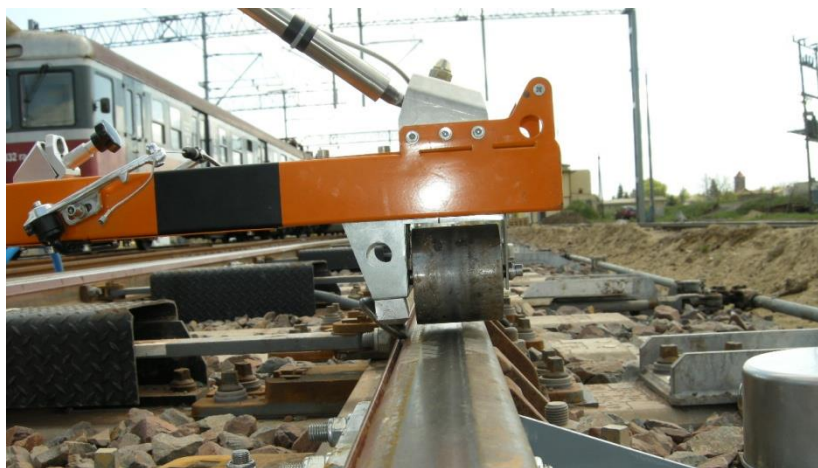
Fot. 3. Uniesione kółko pomiarowe
