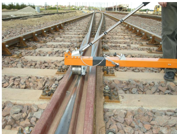
Fot. 5. Przejazd przez dziób krzyżownicy
