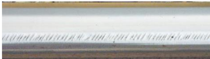
Rys. 4. Pęknięcia head checks
