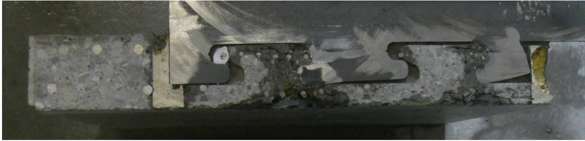
Bild 14: Prüfkörper Nr. 6 nach dem Zerlegen: verformter Stahlsteg
