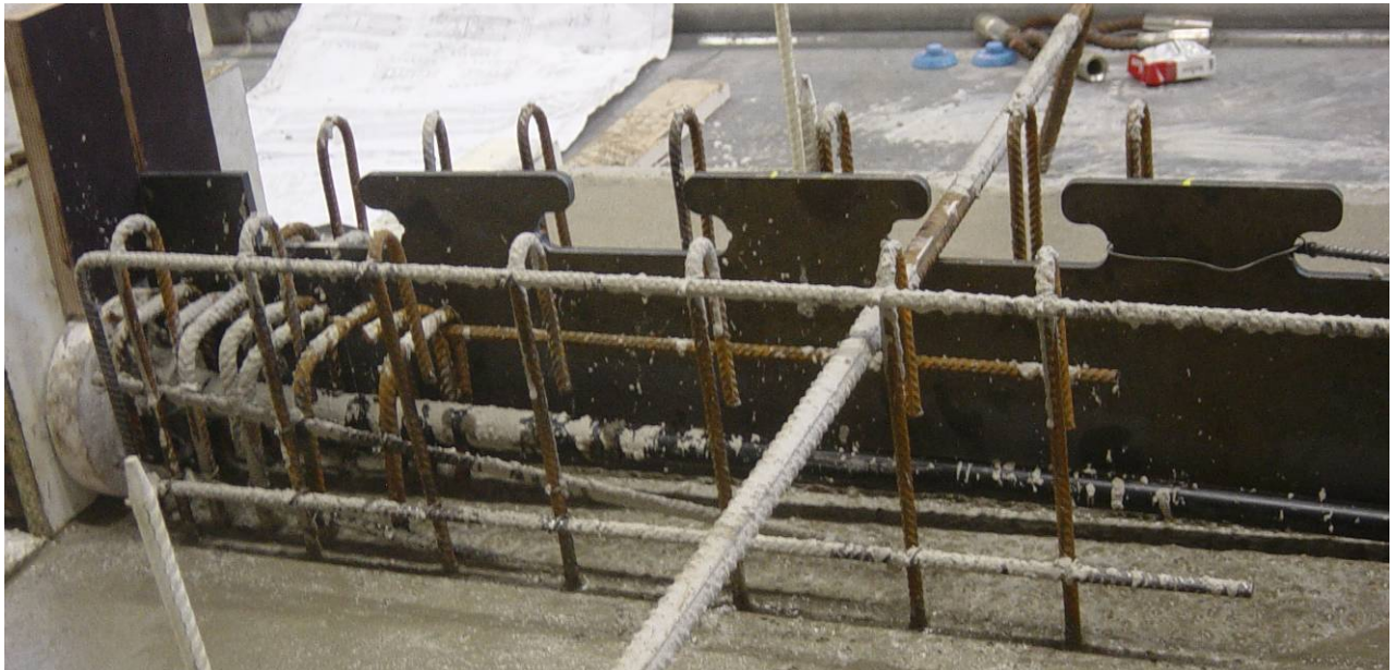
Bild 4: Geometrie einer Puzzleleiste
