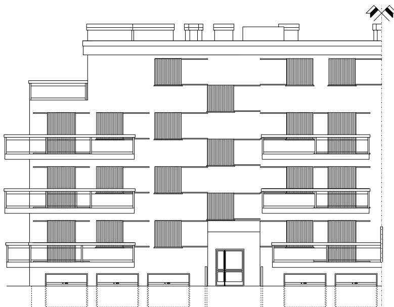
II. 2. Przykładowa elewacja budynku z okiennicami przesuwными – stan zamknięty
