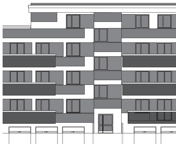
II. 2. Przykładowa elewacja budynku z okiennicami przesuwными – stan zamknięty
