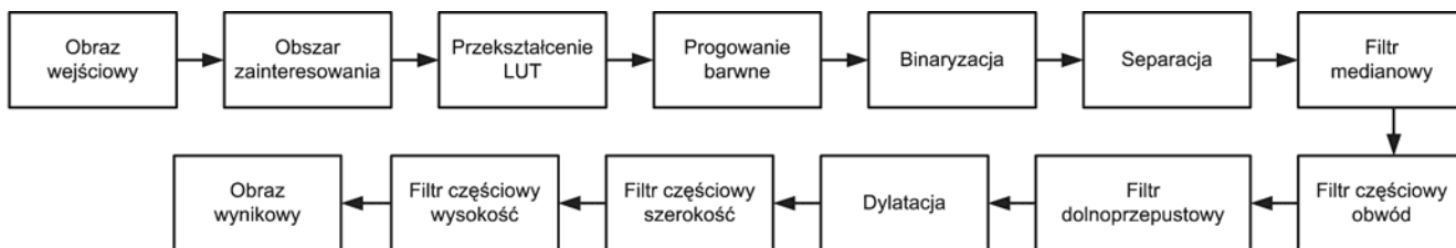
Rys. 2. Schemat blokowy algorytmu wstępnej obróbki obrazu
