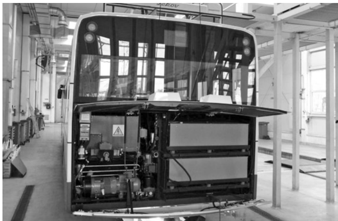
Fot. 5. Dwa moduły baterii niklowo-kadmowych zabudowanych w trolejbusie Solaris Trollino 12M w Gdyni, fot. Mikołaj Bartłomiejczyk
