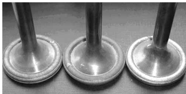
Rys. 2. Zawory po napawaniu laserowym Fig. 2. Valves after laser hard-facing
