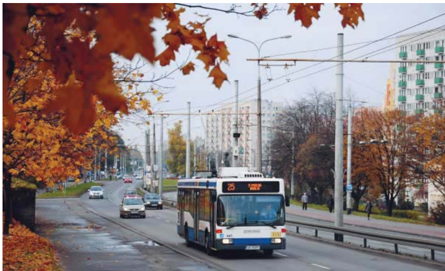
Fot. 10.jpg: Piąty egzemplarz trolejbusu MB O405N2AC z napędem asynchronicznym, (fot. K. Jacobson, Gdynia, ul. Morska, 29.10.2010 r.)
