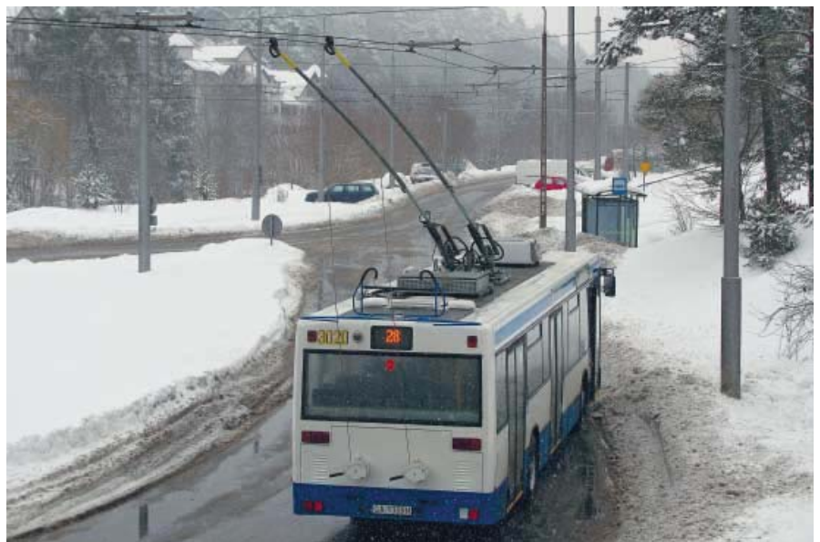
Fot. 03.jpg: Drugi egzemplarz trolejbusu MB O405N2AC z napędem asynchronicznym. Na dachu pojazdu umieszczona przetwornica statyczna, podstawa z odbierakami prądu i rezystor hamowania, nr tab. 3020 (fot. K. Grzonka, Gdynia, pętla autobusowo-trolejbusowa Pustki Cisowskie, 14.02.2010 r.)
