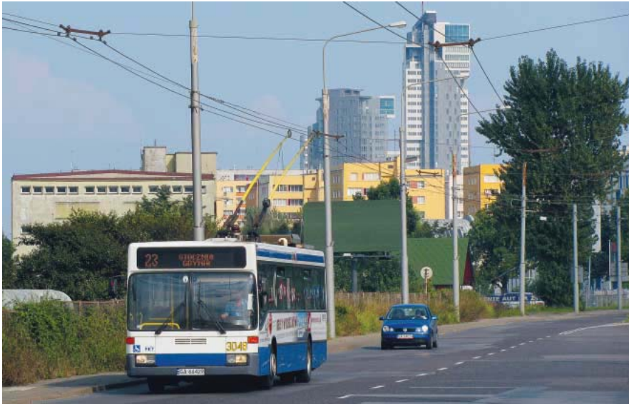
Fot. 02.jpg: Drugi egzemplarz trolejbusu MB O405N2 z napędem stycznikowym, nr tab. 3048 (fot. K. Grzonka, Gdynia, ul. Janka Wiśniewskiego, 11.08.2010 r.)
