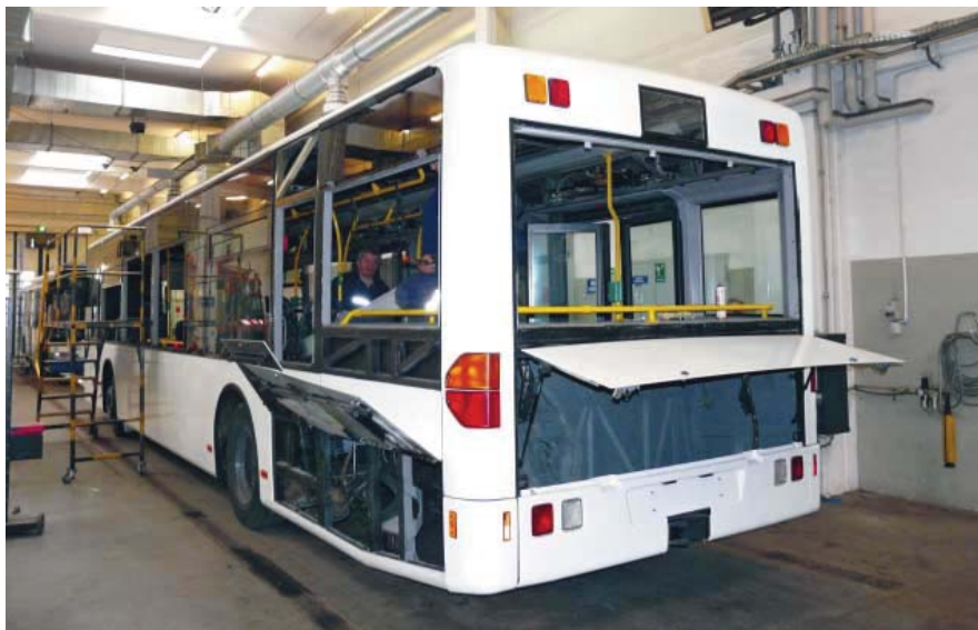
Przystosowywanie tylnej części pierwszego nadwozia Mercedes Benz O530 do zabudowy aparaturą napędu elektrycznego, Gdynia, zajezdźnia trolejbusowa na Grabówku, 24.03.2011 r.
