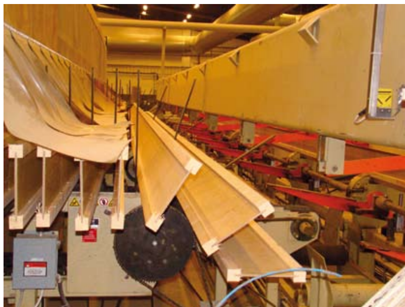
Belki typu I-beams na linii produkcyjnej zakładu Masonite Beams w Rundvik.
