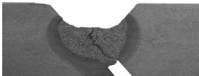
Rys. 5. Przekrój złącza próbnego W1 (S500M) z pęknięciem w spoinie zainicjowanym w grani. Traw. nital
