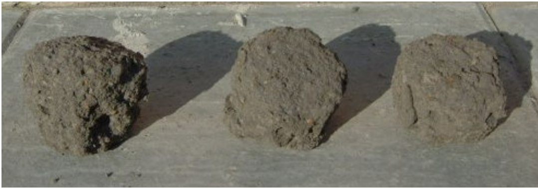
Zdjęcie 6. Próbkki mieszanki popiołowo-piaskowej stabilizowanej cementem po badaniu mrozoodporności
