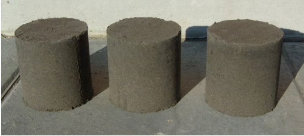
Zdjęcie 5. Próbkki mieszanki popiołowo-piaskowej stabilizowanej cementem
