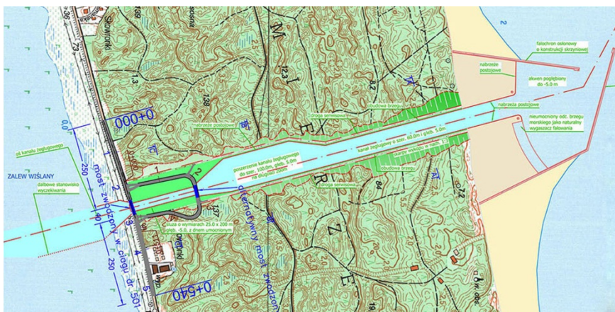
Rys. 2. Plan i zasadnicze budowle kanału żeglugowego przez Mierzę Wiślaną Fig. 2. Scheme and main object of the navigation channel across the Vistula Spit
