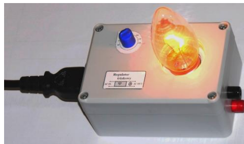
Rys. 10. Zdjęcie zrealizowanego układu ściemniacza
