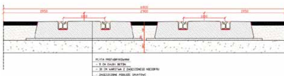
4. Przekrój poprzeczny pasa autobusowo-tramwajowego w Toruniu
