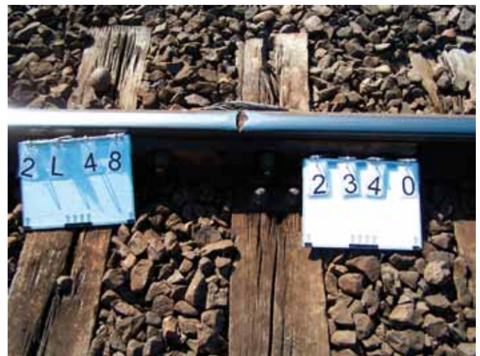
7., 8. Rozwój wady 227 squat (pęknięcie i miejscowe zagłębienie powierzchni tocznej) w torze nr 2 w lewym toku szynowym w km 482,340
