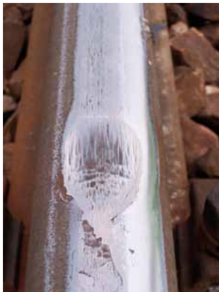
3., 4. Wada 2252 wielokrotne wybukoswanie w torze nr 1 w lewym toku szynowym w km 467,675 – 467,679
