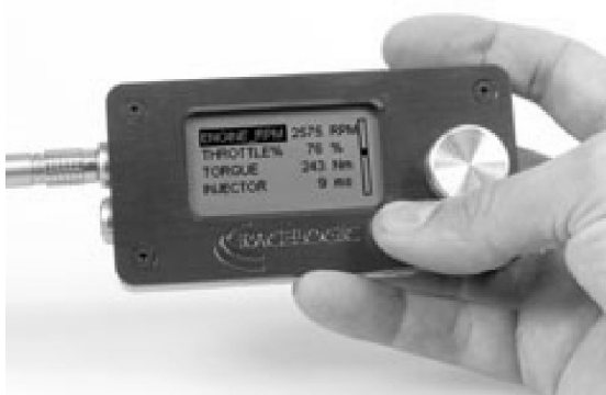
Rys. 6. Urządzenie wykorzystane w badaniach do rozpoznania identyfikatorów ramek wiadomości transferowanych w magistrali CAN [159]
