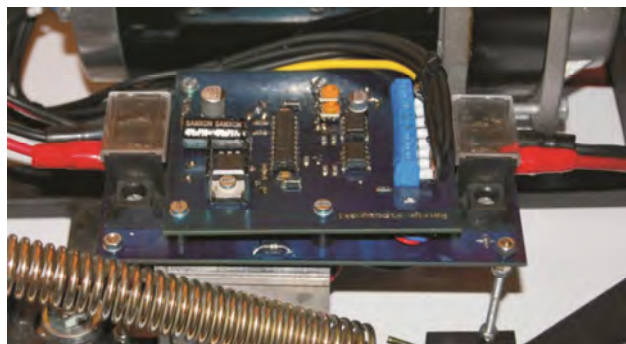
Rys. 12. Widok mostka H
