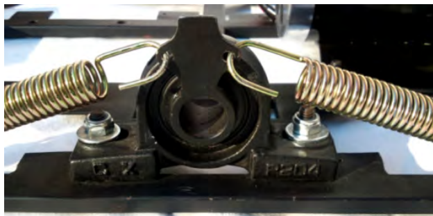
Rys. 3. Mocowanie drążka kierowniczego
