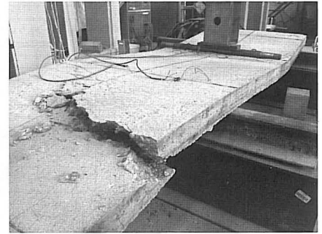
Rys. 9. Płyta nr 3 po zniszczeniu
