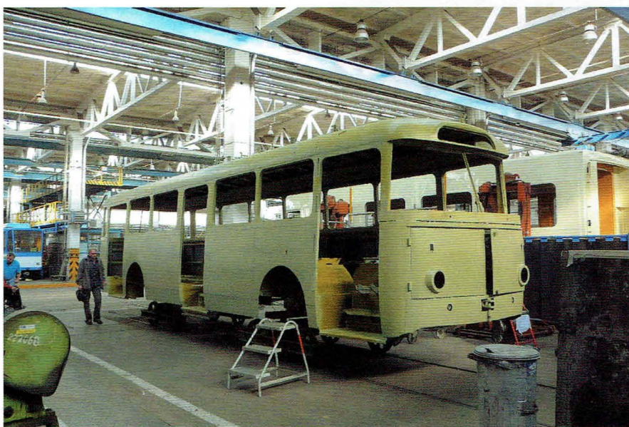
Konserwacja nowego poszycia trolejbusu. Widoczne, odtworzone, oryginalne śrubowanie na styku arkuszy blach
