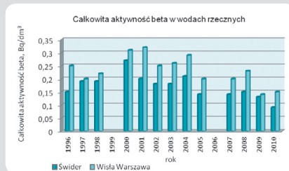
Rys. 6. Analiza całkowitej aktywności beta w wodach rzecznych na terenie ośrodka w Świerku na podstawie [6]
