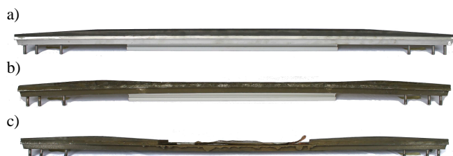
Rys. 1. Widok z boku nowej (a), znacznie zużytej (b) oraz uszkodzonej (c) nakładki stykowej
