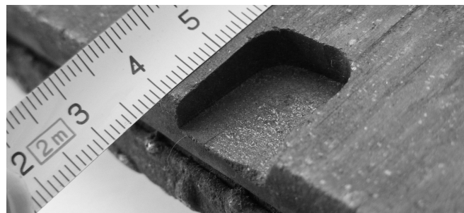
Rys. 9. Fotografia spreparowanego uszkodzenia nakładki stykowej
