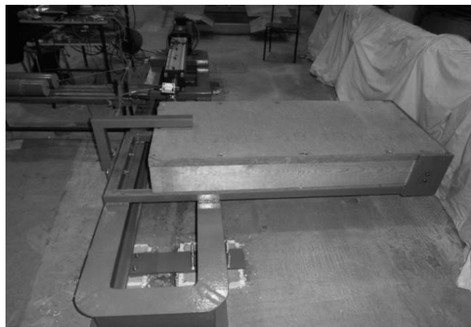
Rys. 1. Widok stanowiska badawczego z zamocowanym elementem ściennym
