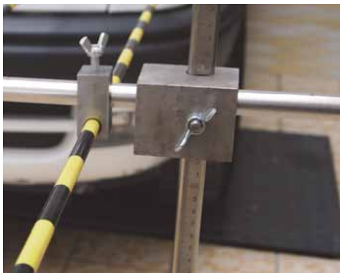
Rys. 3. Połączenie listew poziomej i pionowej
