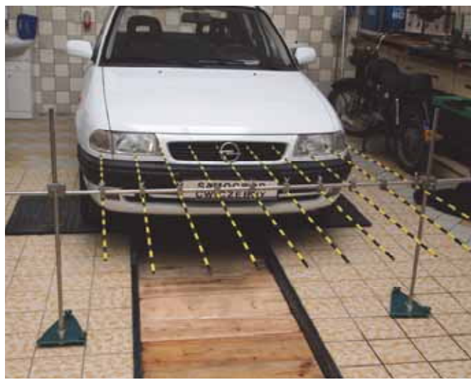
Rys. 5. Pomiar kalibracyjny w warunkach warsztatowych
