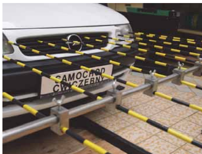
Rys. 4. Widok mocowania prętów pomiarowych do listwy poziomej
