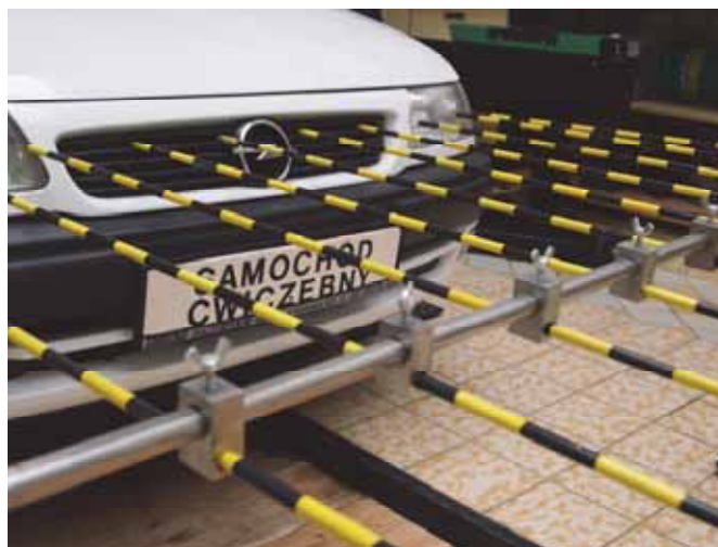
Rys. 4. Widok mocowania prętów pomiarowych do listwy poziomej
