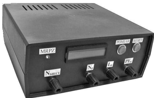
Rys. 6. Widok modelu miernika rezystancji pętli zwarciowej bez wyzwalania RCD [17]
