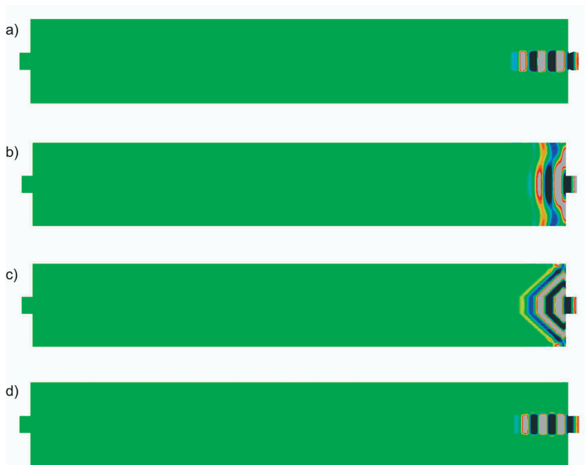
Rys. 7. Propagacja fali (składowa v_z – wzdłuż osi pręta) w chwili czasowej t = 2,8e-5 s w prętach otoczonych: a) powietrzem b) E = 37 GPa; c) E = 5 GPa; d) E = 0,5 GPa
