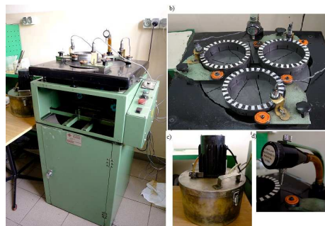
Rys.2. Widok ogólny: a) docierarka jednotarczowa ABRALAP 380, b) układ wykonawczy obrabiarki, c) zbiornik zawiesziny ścierniej z pompą, d) układ dozujący zawiesinę
